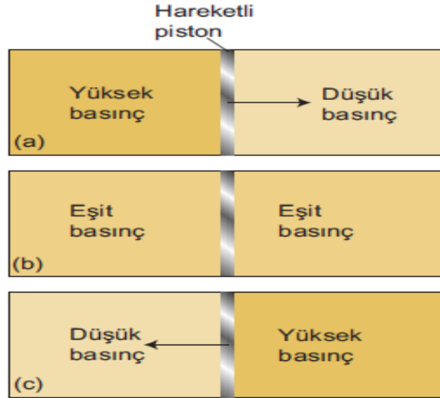
Şekil 1.1 Yüksek basınçlı bir bölge düşük basınçlı bir bölgeden hareketli bir pistonla ayrıldığında, piston a veya c'deki gibi, bir yöne veya diğerine hareket eder. Ancak, iki basınç birbirine eşitse, piston hareket etmez (b). Bu durum, iki bölge arasında mekanik denge olduğunu gösterir.
