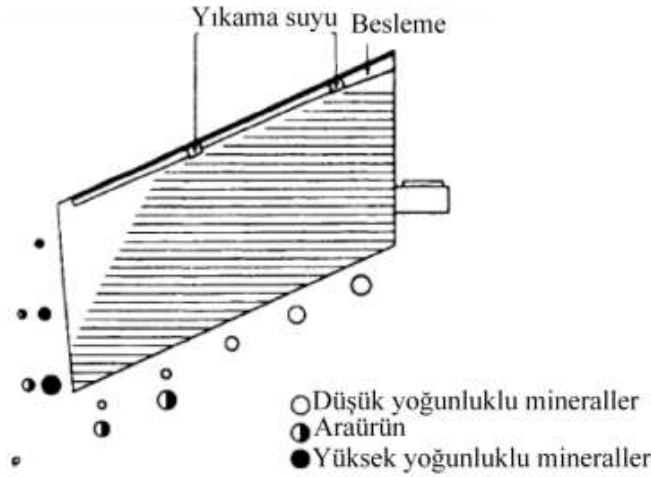
Şekil 15. Farklı yoğunluk ve boydaki tanelerin masa hareketi doğrultusundaki dizilimi.
