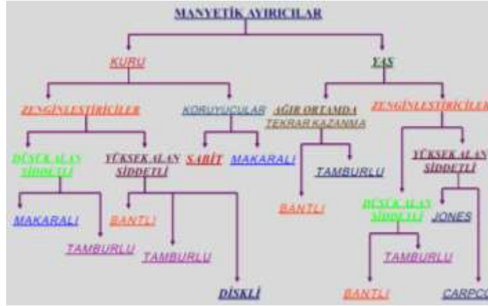
Şekil 16. Manyetik ayırıcıların sınıflandırılması.
